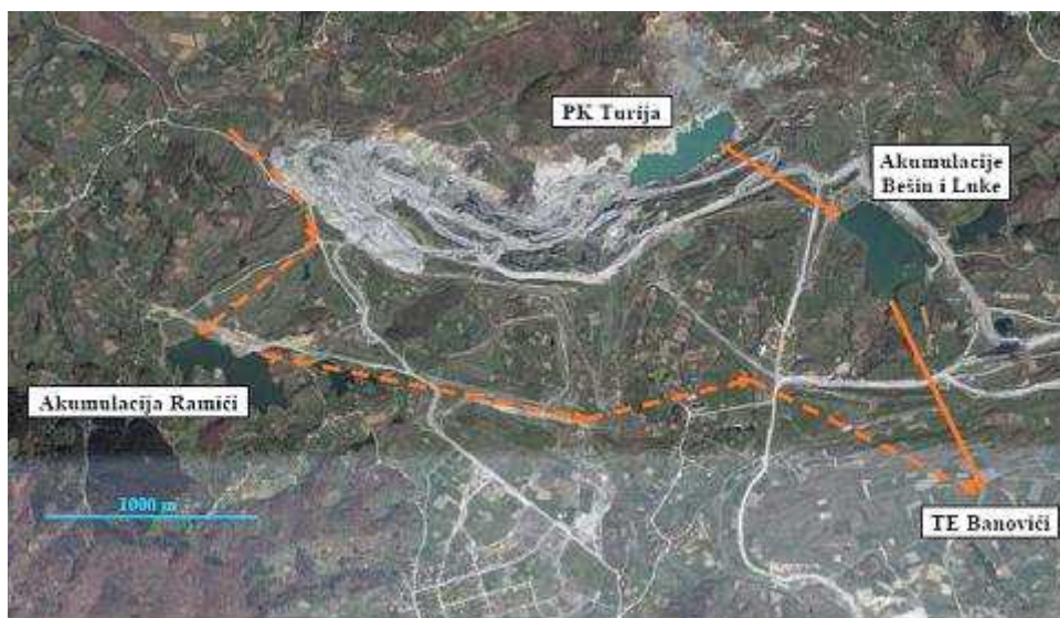
ILUSTRACIJA 9: AKUMULACIJE NASTALE ODVODNJAVANJEM POVRŠINSKOG KOPA RUDNIKA
