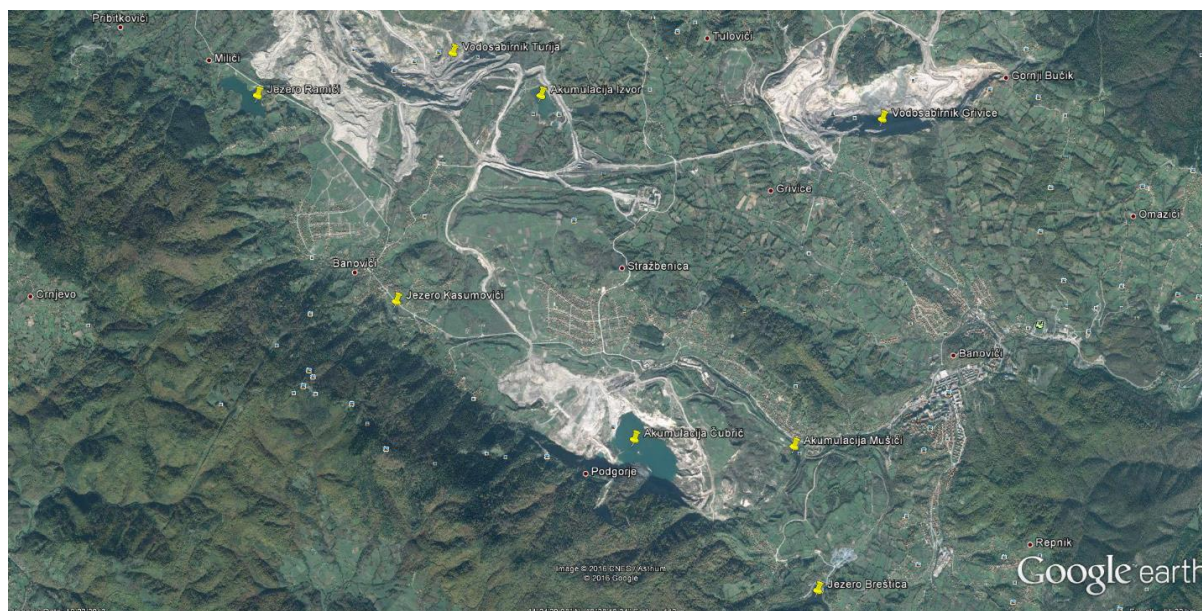
ILUSTRACIJA 5: AKUMULACIJE NASTALE IZVOĐENJEM RUDARSKIH RADOVA PRI POVRŠINSKOJ EKSPLOATACIJI UGLJA [Izvor: Tehnička dokumentacija Rudnika Banovići]
